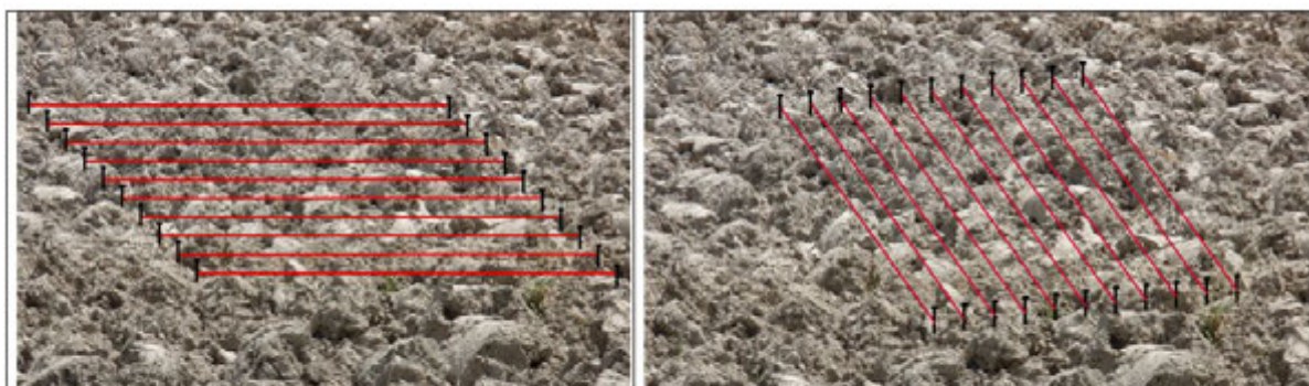
Figura 11. Misure dell'indice di tortuosità con il metodo della catenella (a sinistra le sezioni sono perpendicolari alla direzione della lavorazione, mentre a destra sono nella direzione della lavorazione).
