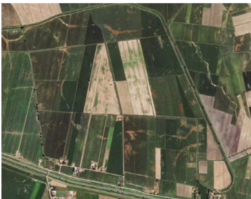
Figura 4. Danni da eccesso idrico in terreni di pianura in un'annata caratterizzata da abbondanti piogge autunno-vernine evidenziati dal colore bruno della vegetazione (Immagine Google Earth, giugno 2013, nel comune di Padova).
