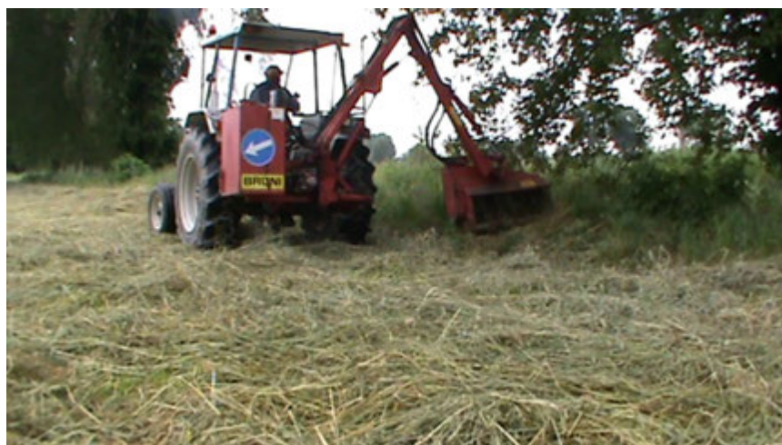
Figura 21. Azienda Baroncina (Lodi). Trattamento fattuale con pulizia del fosso collettore mediante trinciatura della flora avventizia (erbacea ed arbustiva) con decespugliatore portato marca “Bruni” a 18 coltelli.
