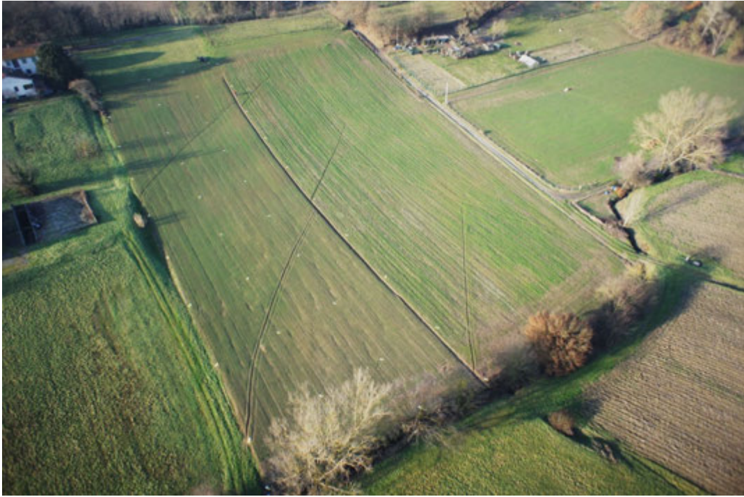
Figura 5. Sito di monitoraggio nell'azienda Fagna (foto da drone). Si notino le mire posizionate a distanze regolari (ground Reference Points) per la georeferenziazione delle immagini zenitali.
