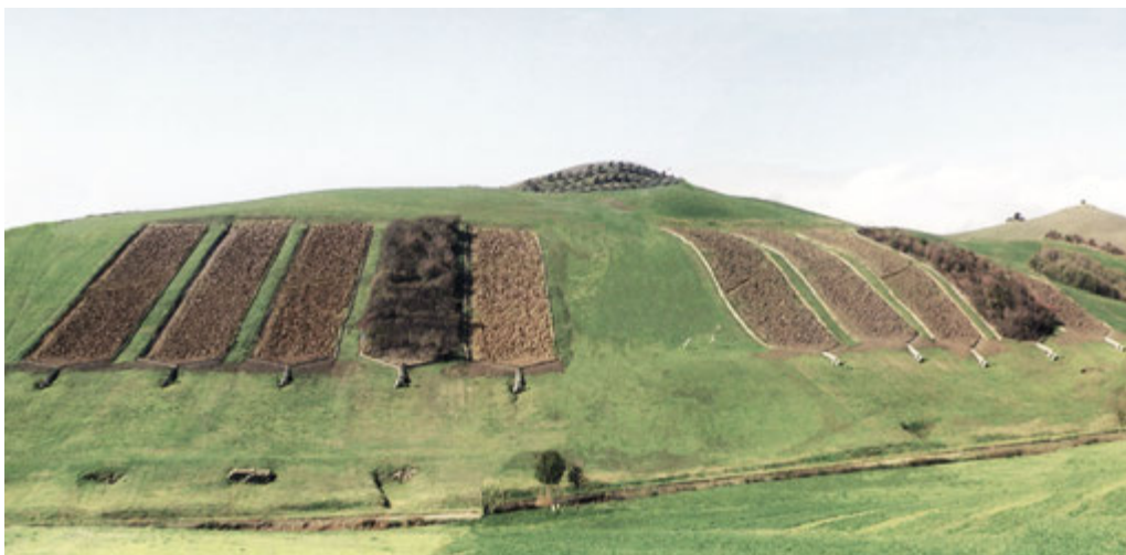
Figura 3. Impianto parcellare nell'azienda Santa Elisabetta per la misura dei deflussi e dell'erosione.
